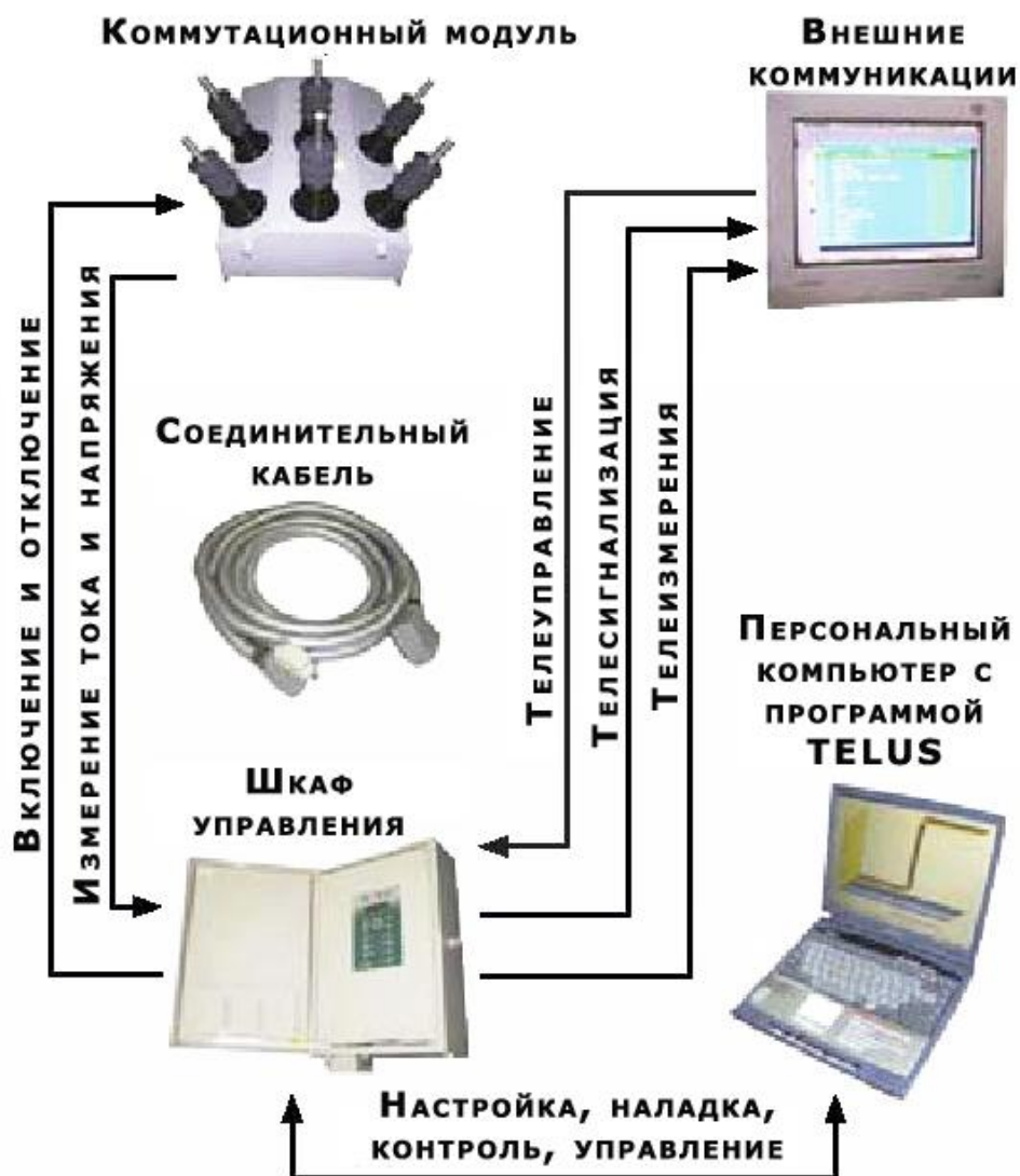
Рисунок 10.8 – Принципиальная схема реклоузера
