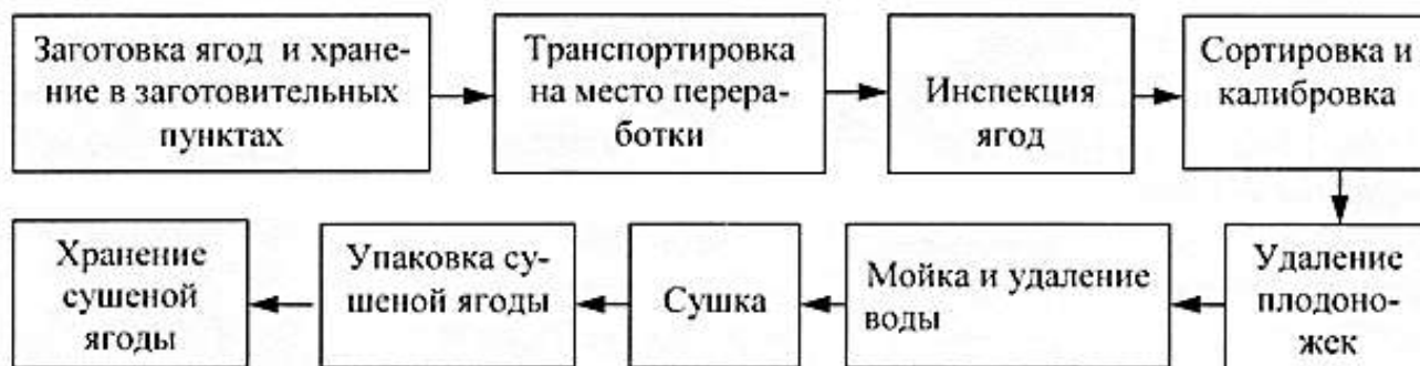
Рисунок 3.1 – Технологическая схема производства сушеных ягод
