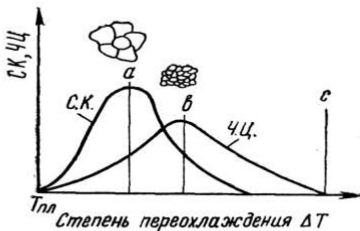
Рис. 7. Зависимость скорости роста кристаллов (с.к.) и скорости зарождения центров кристаллизации (ч.ц.) от степени переохлаждения
