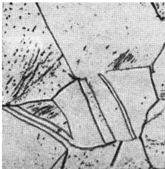
Рис. 71. Микроструктура деформированной и отожженной меди \times 200
