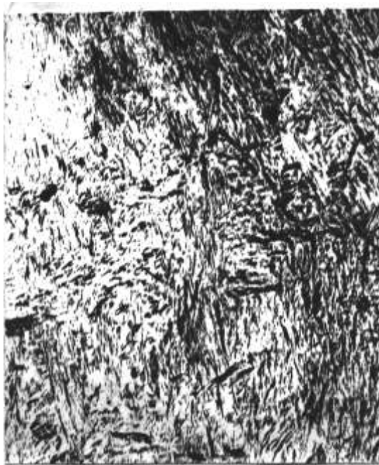
Рис. 52. Микроструктура закаленной стали (мартенсит), \times 500
