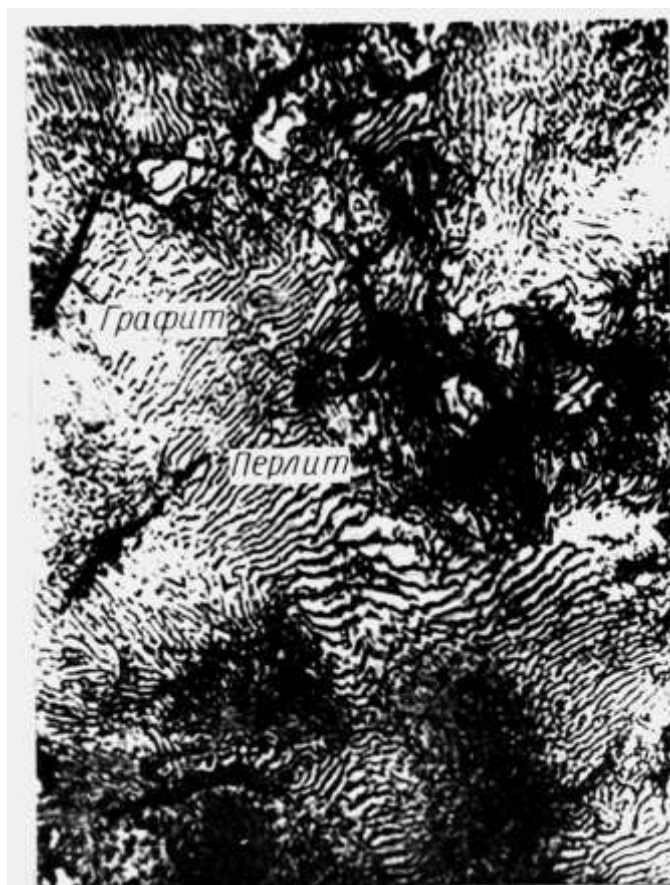
Рис. 45. Микроструктура серого перлитного чугуна \times 1000
