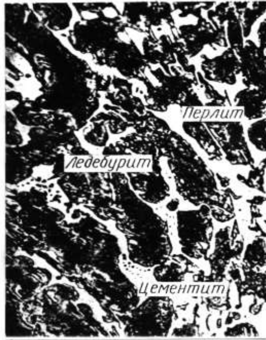
Рис. 42. Микроструктура доэвтектического чугуна \times 200
