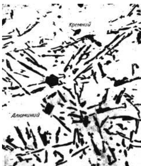
Рис. 75. Микроструктура литейного алюминиевого сплава марки АЛ12 до модифицирования \times 200
