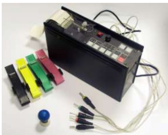
Рисунок 64 – Электрокардиограф ЭКГ-05-АСК «Малыш»
