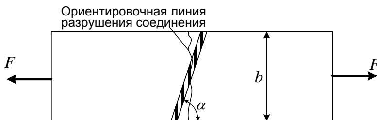
Рис. 2.2. Схема косого сварного соединения
