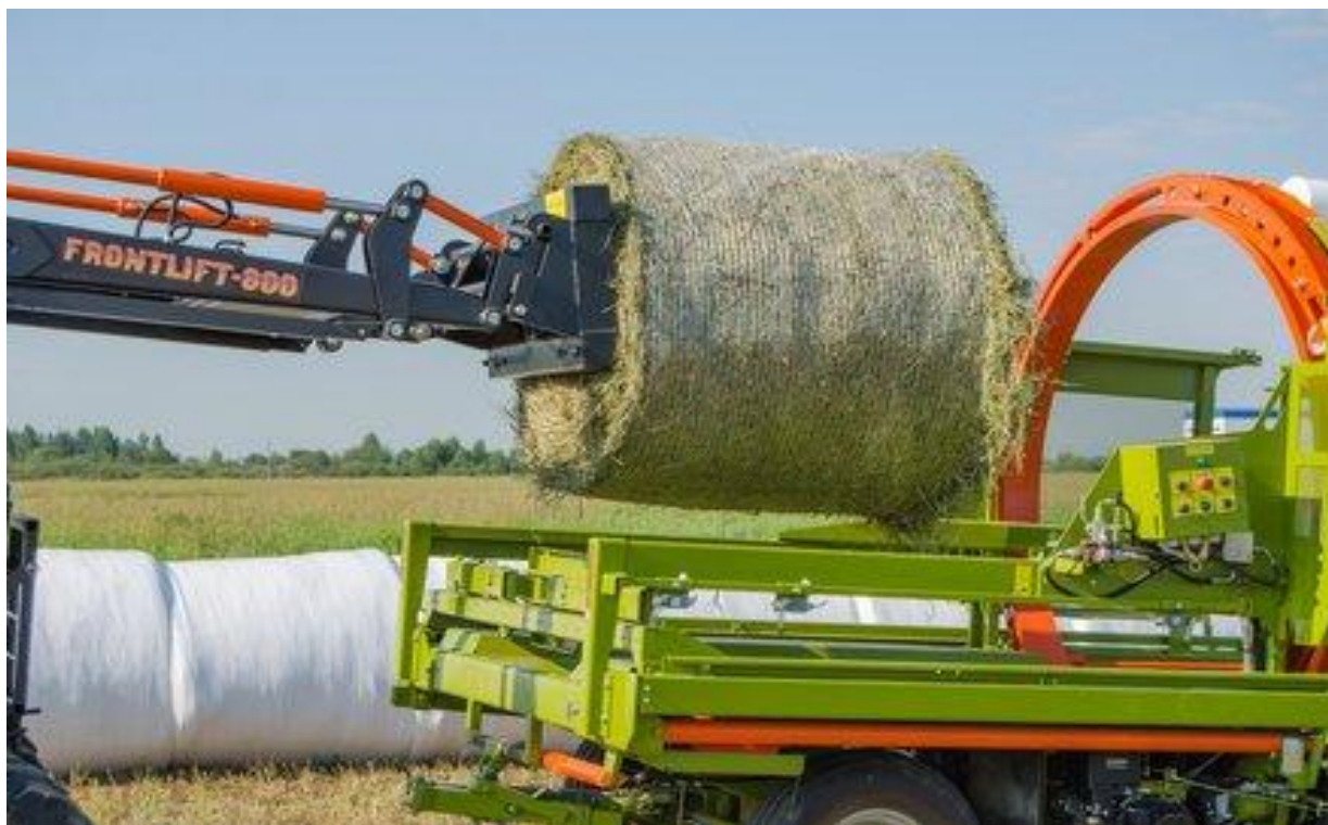
Рисунок 36 – Упаковка рулона сенажа в пленку упаковщиком SPEED WAY 120
