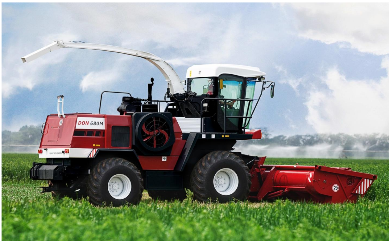
Рисунок 40 – Комбайн кормоуборочный самоходный DON 680M
