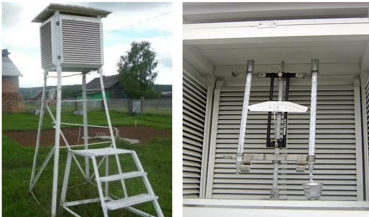
Рисунок 13 – Психрометрическая будка на метеостанции (слева) и станционный психрометр (справа)
