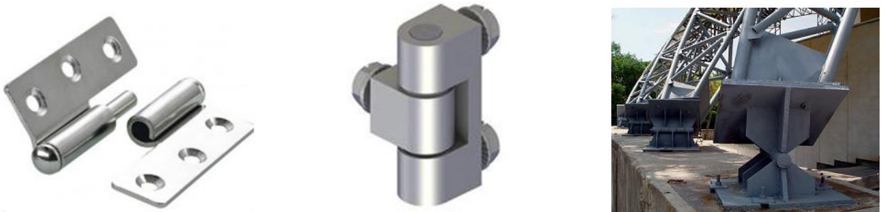
Рисунок 1.24 – Примеры шарнирно-неподвижных опор
