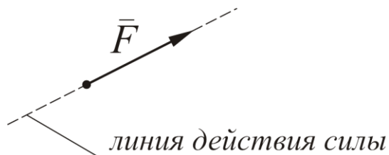
Рисунок 1.1 – Линия действия силы
