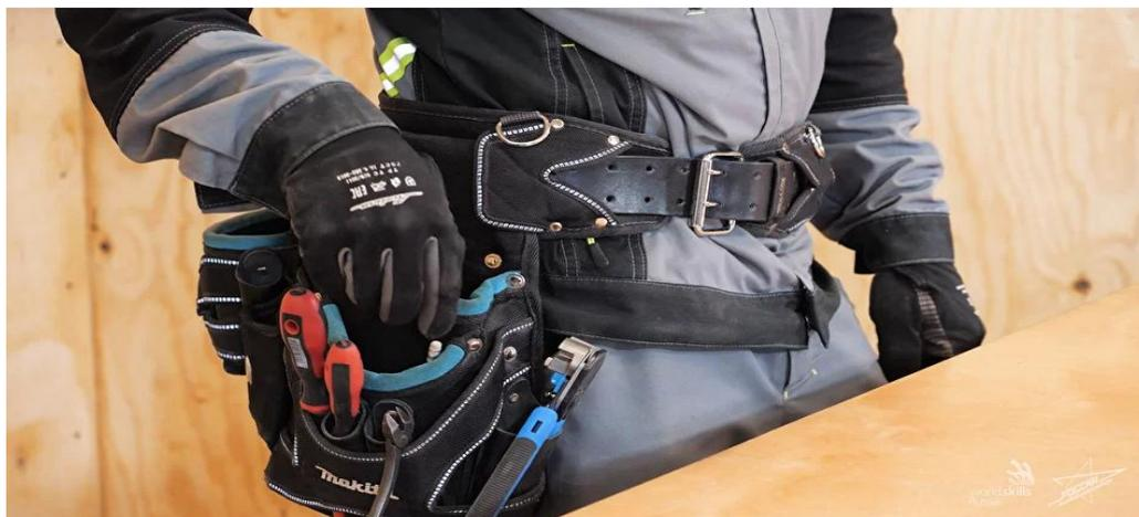
*Рисунок 2 – Монтажный пояс с ручным инструментом*
