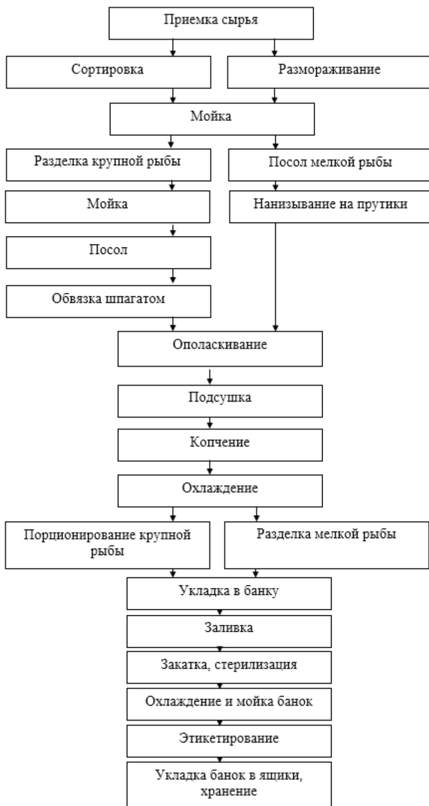
Рисунок 36 – Схема производства консервов из копченой рыбы в масле
