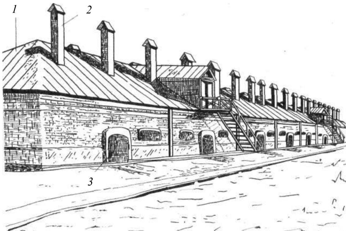
Рисунок 27 – Камерная коптильная печь астраханского типа: 1 – коптильная камера; 2 – вытяжная труба; 3 – двери камеры
