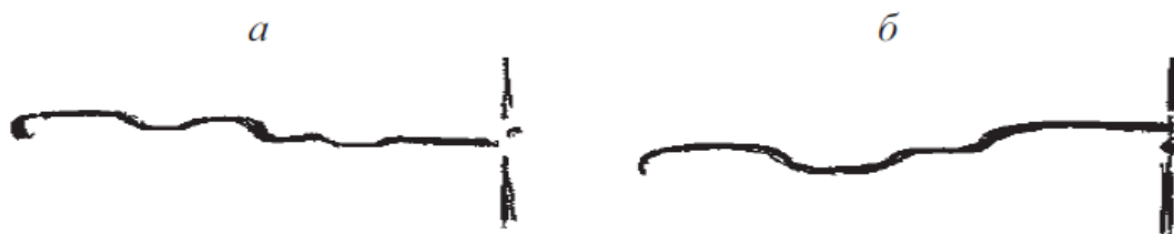
Рисунок 21 – Рельеф концов жестяной банки: а – обычный; б – обратный
