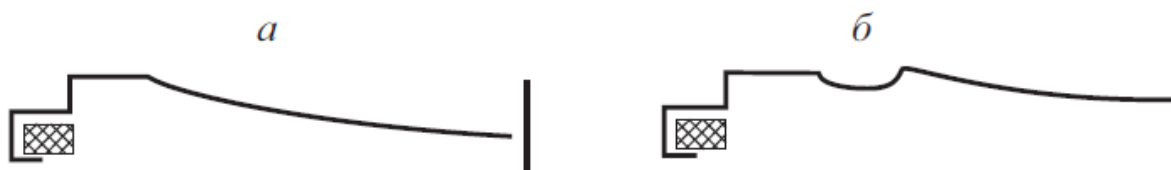
Рисунок 31 – Профили крышек различного исполнения: а – исполнение 1; б – исполнение 2
