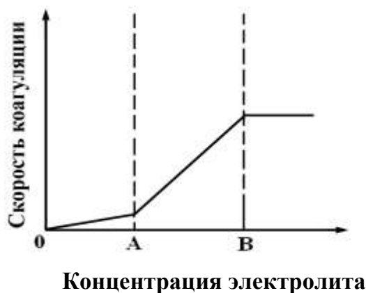
Рис. 7.1. Зависимость скорости коагуляции от концентрации электролита
