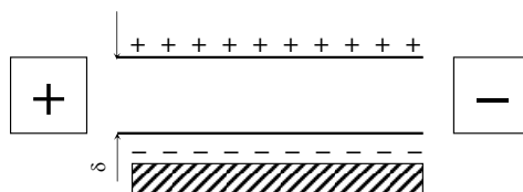
Рис. 5.4. Поведение ДЭС при электрокинетических явлениях
