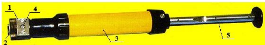
Рис. 1.3. Внешний вид насоса-пробоотборника: 1 – насадка; 2 – переходная втулка; 3 – цилиндр; 4 – сигнальное устройство (индикатор завершения прососа); 5 – шток
