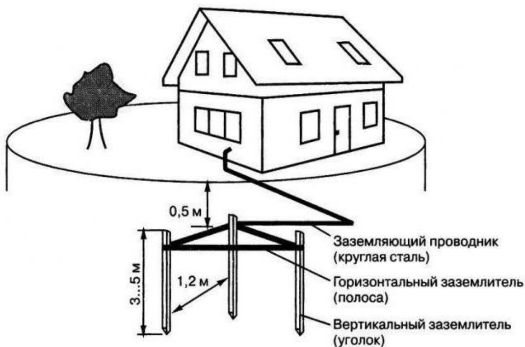
Рис. 4.1. Заземляющее устройство
