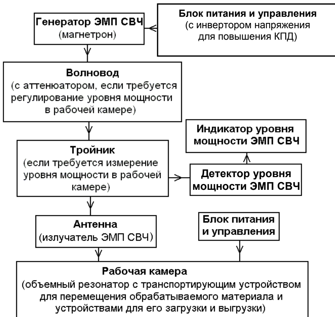
Рис. 7.1. Структурная схема СВЧ-установки для предпосевной обработки семян
