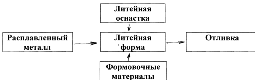
Рисунок 8 – Схема технологического процесса получения отливок в песчано-глинистые формы
