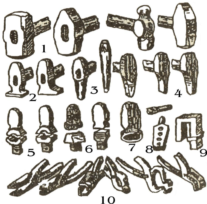
Рисунок 41 – Инструмент для свободнойковки: 1 – кувалды; 2 – гладилки; 3 – прошивни; 4 – зубила; 5 – обжимки; 6 – подбойки; 7 – вершник; 8 – гвоздильни; 9 – скоба; 10 – клещи
