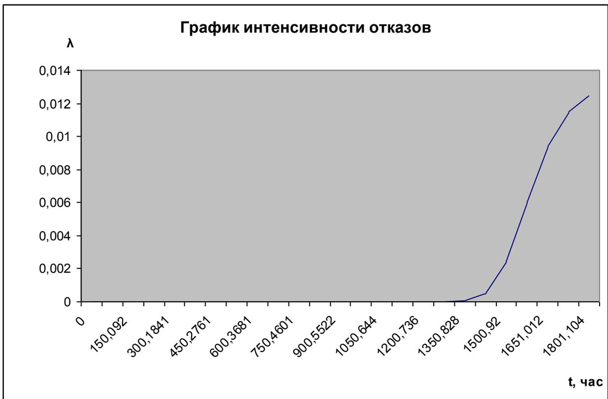
Рисунок 5.18 – Графическая зависимость  $\lambda_i(t)$  от наработки  $t$
