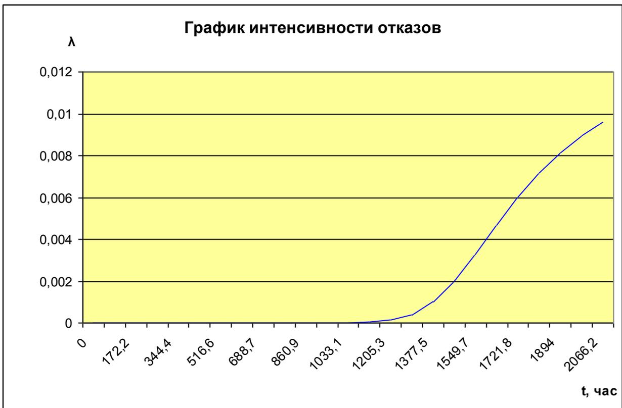
Рисунок 5.13 – Графическая зависимость  $\lambda_i(t)$  от наработки  $t$
