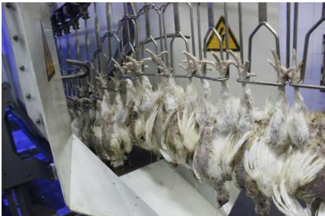
*Рисунок 3 – Линия навешивания птицы*
