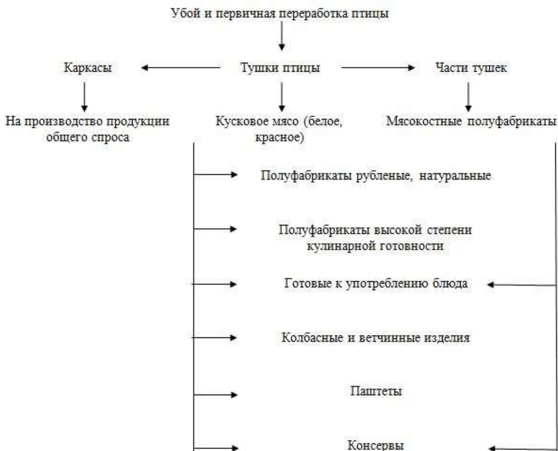
Рисунок 10 – Схема переработки птицы
