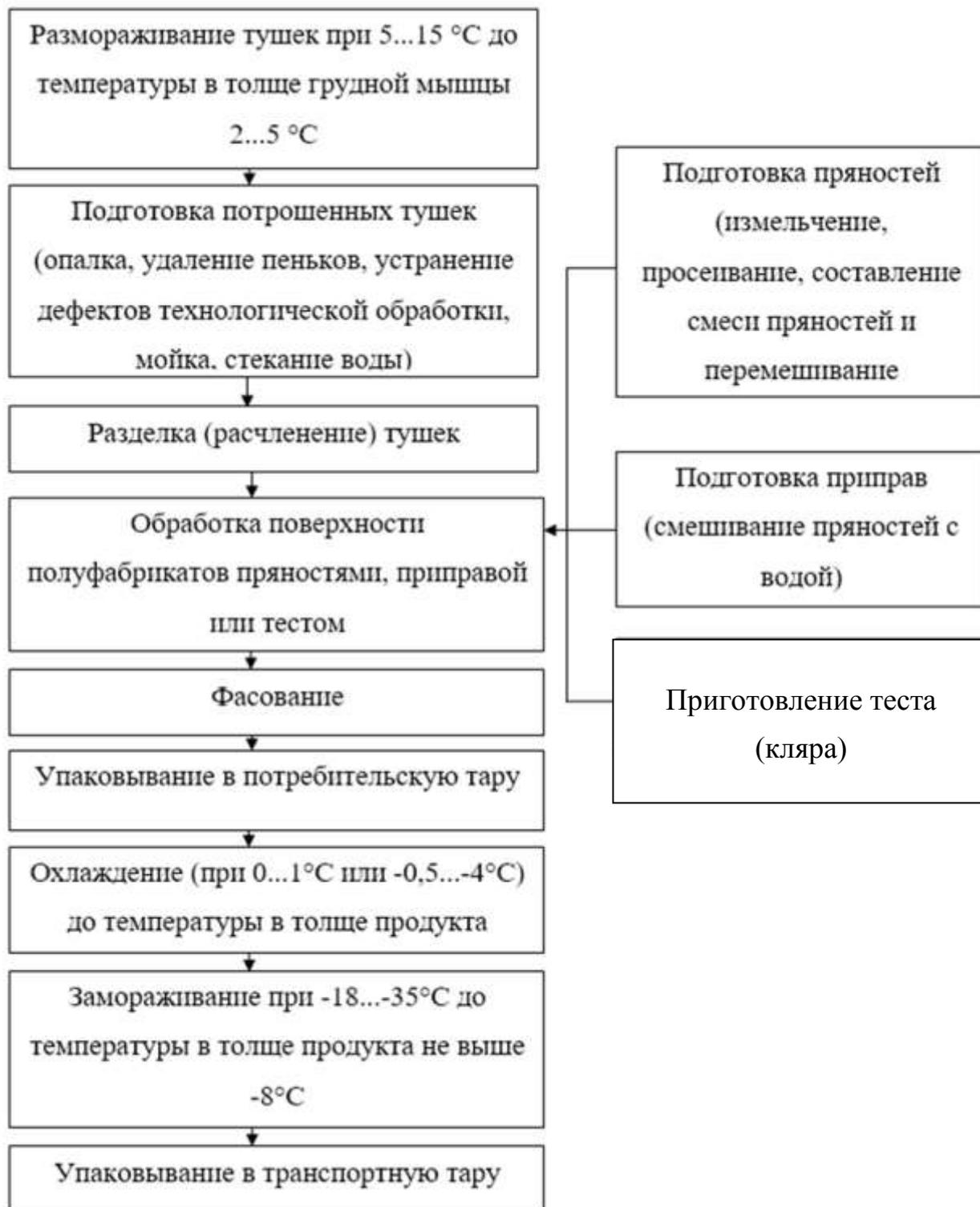
Рисунок 24 – Технологическая схема производства натуральных полуфабрикатов из мяса птицы
