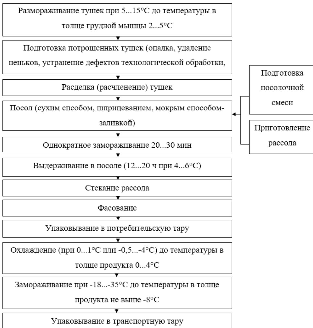
*Рисунок 25 – Технологическая схема производства маринованных полуфабрикатов из мяса птицы*
