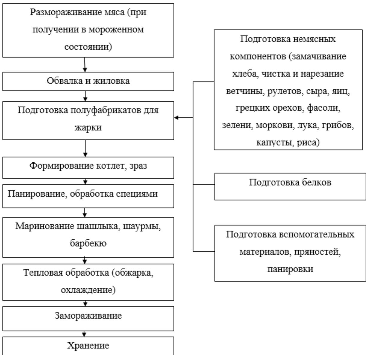
Рисунок 33 – Технологическая схема производства кулинарных изделий из мяса птицы
