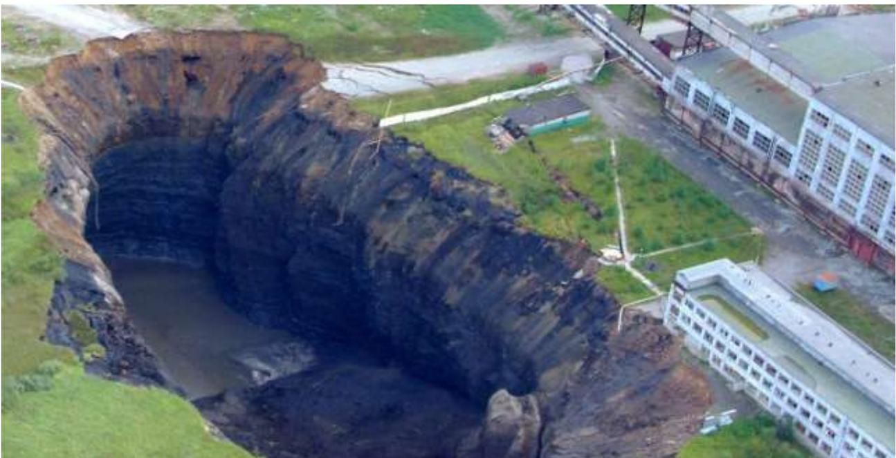
*Рисунок 24 – Провал – результат производства подземных разработок*
