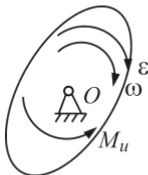
Рисунок 3.5 – Неравномерное вращение звена относительно центра тяжести
