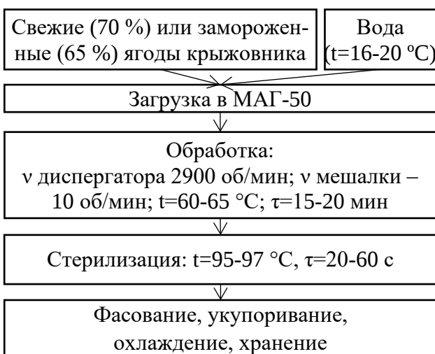
Рисунок 4 - Принципиальная схема производства полуфабриката из ягод крыжовника в среднем на 21,1 и 20,3 % (табл. 3). В полуфабрикатах из быстрозамороженных
