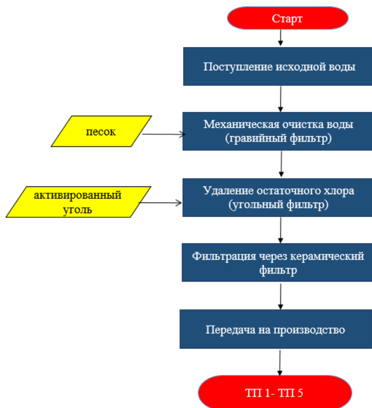
Рисунок 3.23 – Технологическая схема водоподготовки
