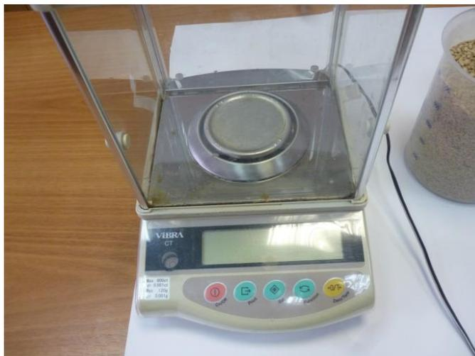
Рисунок 3.4 – Весы аналитические, общий вид
