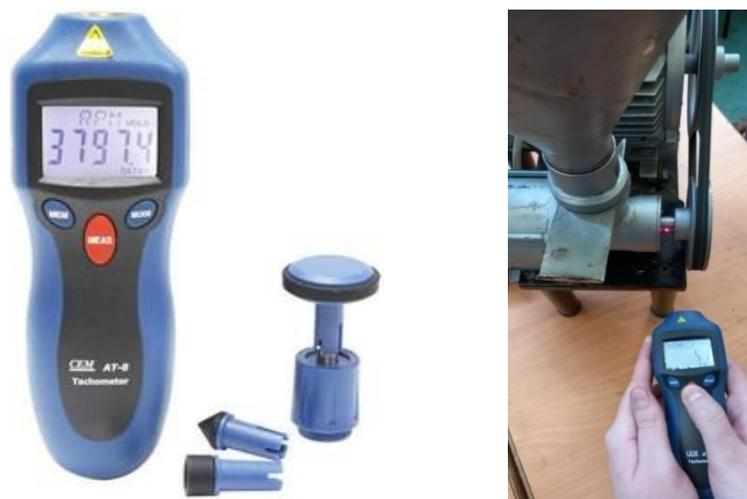
Рисунок 3.3 – Измеритель числа оборотов (тахометр) лазерный, контактно-бесконтактный АТ-8
