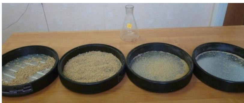
Рисунок 3.10 – Рассев пробы шелушенного зерна
