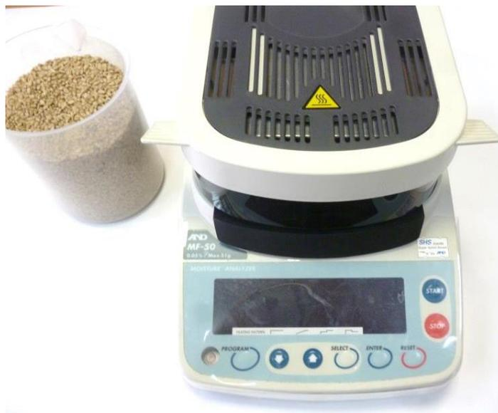
Рисунок 3.5 – Общий вид аналитического анализатора влажности AND MF-50
