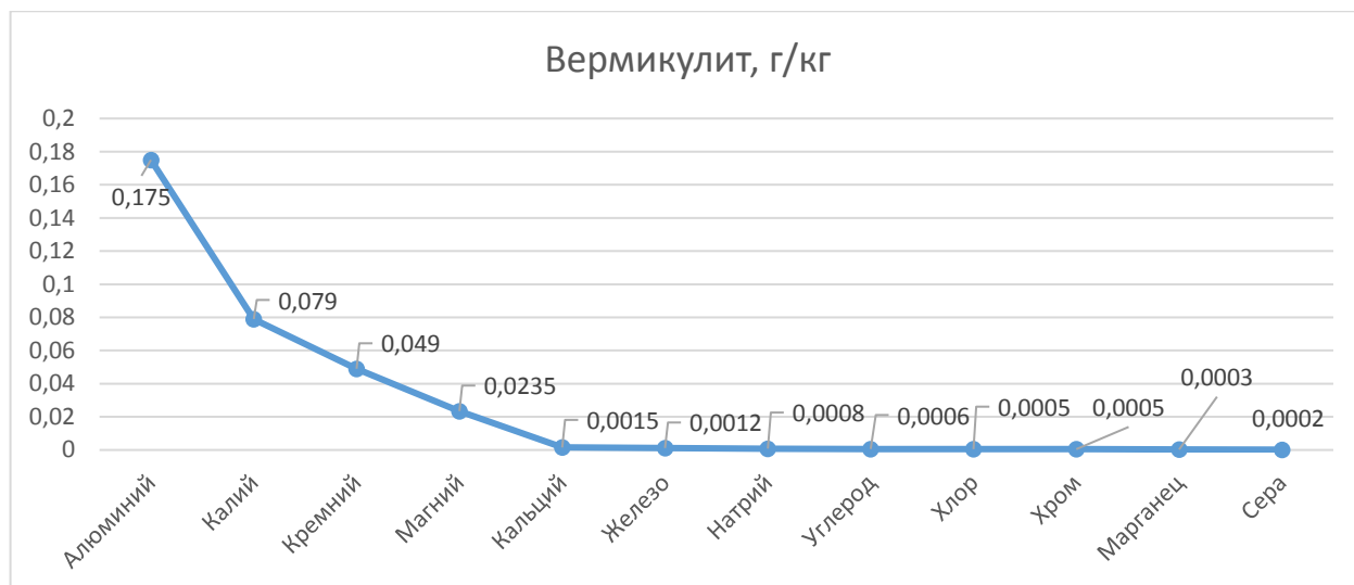
Рисунок 8 – Минеральный состав вермикулита, г/кг
