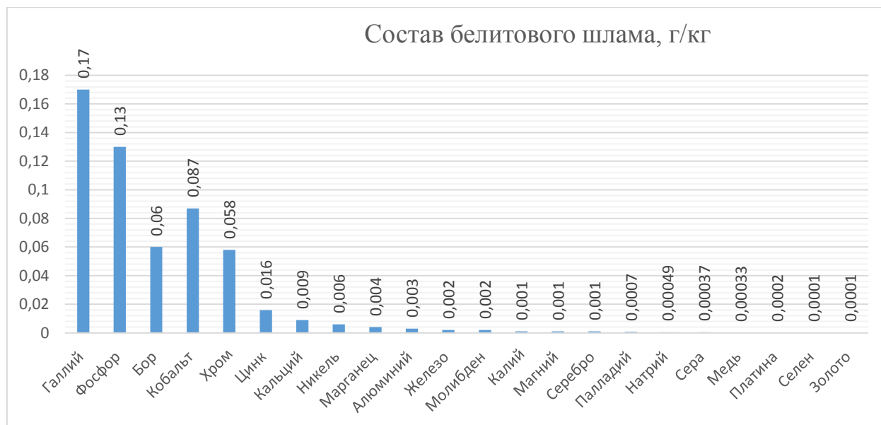
Рисунок 3 – Минеральный состав белитового шлама, г/кг
