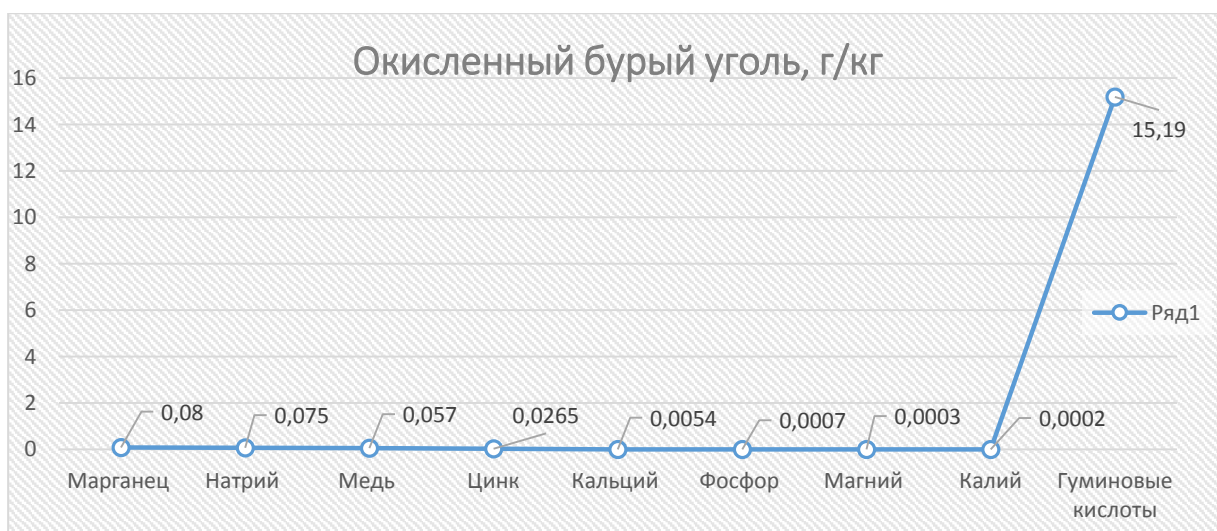
Рисунок 6 – Минеральный состав окисленного бурого угля, г/кг
