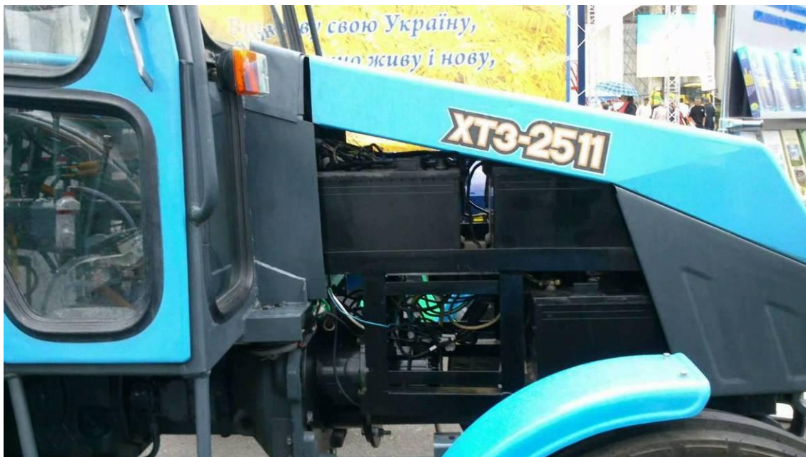
Рисунок 1 - Электротрактор ХТЗ-2511 с литий-ионными батареями вместо двигателя
