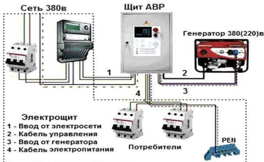
Рисунок 4. Схема подключения АВР.
