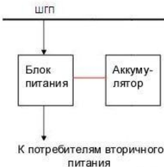
Рисунок 5 – Подключение аккумулятора
