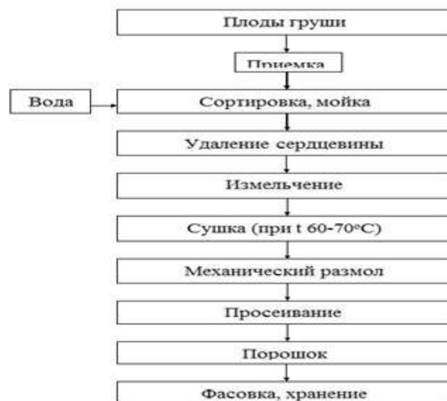
Рисунок 1. Технологическая схема получения грушевого порошка из плодов
