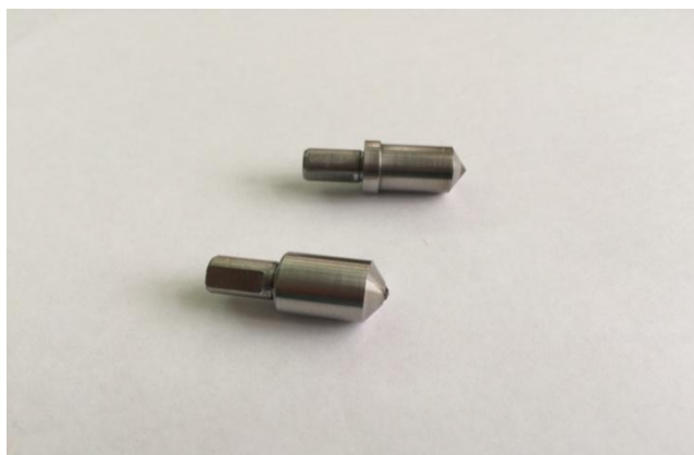
Рис. 3. Алмазные инденторы твердомеров Роквелла и Виккерса
