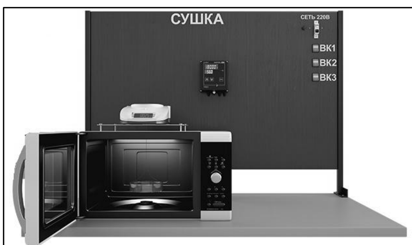
Рисунок 1- Лабораторная установка по исследованию различных способов сушки различных материалов (Модель: ПАХП-СШ)
