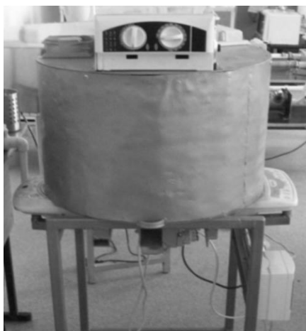
Рисунок 1 – Микронизатор фуражного зерна
