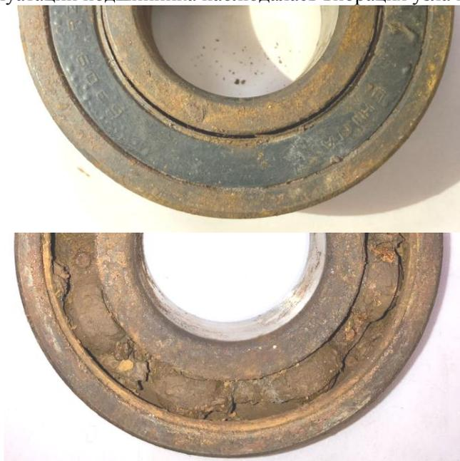
Рисунок 1. Разрушенный подшипник качения
