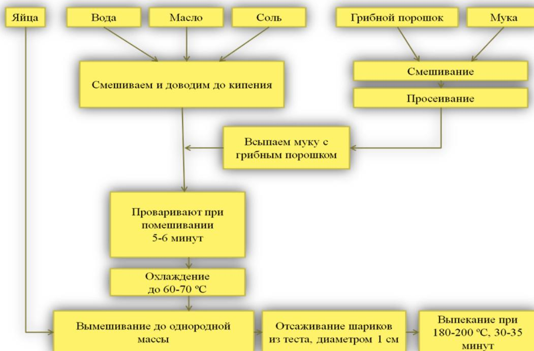
Рисунок 0 – Технологическая блок-схема получения заварного полуфабриката
