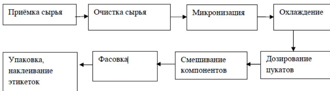
Рисунок 1 – Технологическая схема производства мюсли
