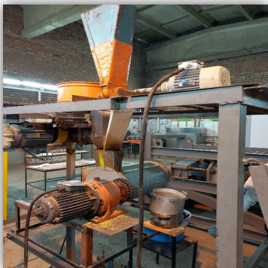
Рисунок 1 – Технологическая линия с модифицированным дозатором в Инжиниринговом центре при Институте пищевых производств
