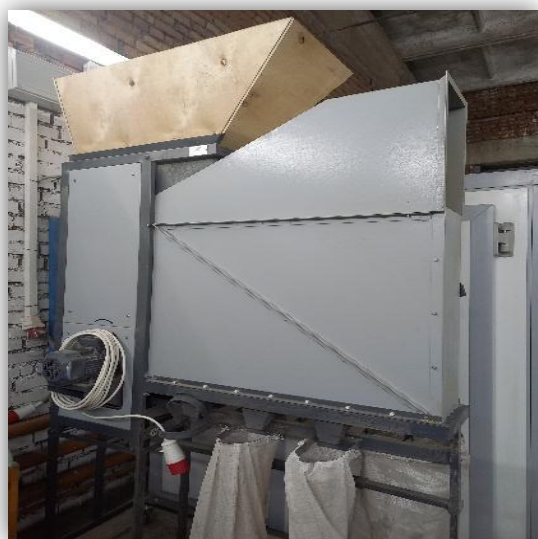
Рисунок 1 – Технологическая линия с модифицированным сепаратором в Инжиниринговом центре при Институте пищевых производств
