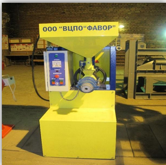
Рисунок 1 – Технологическая линия с модифицированным экструдером в Инжиниринговом центре при Институте пищевых производств
