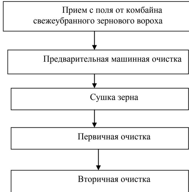
Рисунок 1 –Технологическая схема послеуборочной обработки зерна
