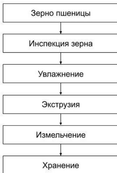
Рисунок 2 – Блок-схема получения экструдата из зерна пшеницы
