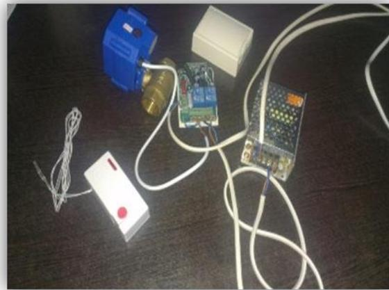
Рисунок 1 – Схема подключений системы защиты ручной сборки
