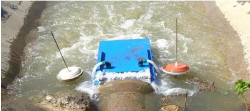
Рисунок 1 – Регулятор урванного режима воды поплавкового типа
