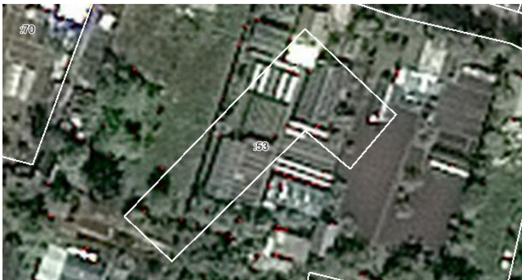
Рисунок 3 – Пример земельного участка с признаками реестровой ошибки в виде поворота земельного участка
