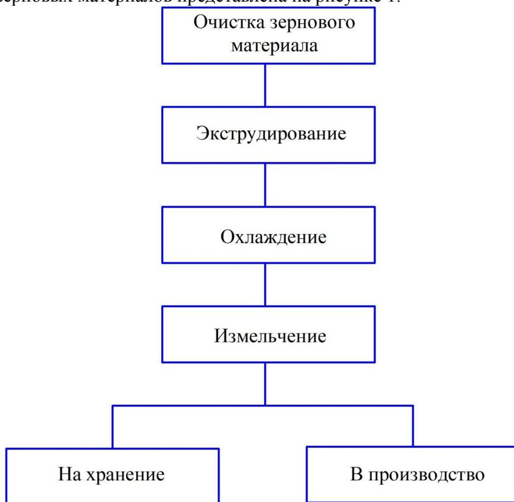
Рисунок 1 – Технологическая схема экструзионной обработки зерновых
