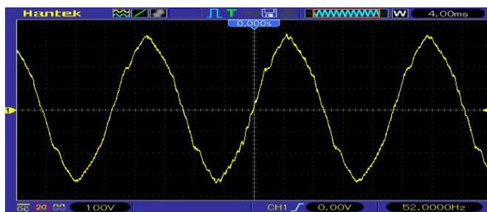
Рисунок 2 – Выходное напряжение на тиристорном(транзисторном) инверторе
