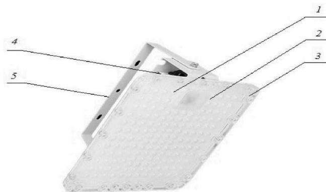
Рисунок 1 – схематический вид конструкции светодиодного облучателя для растений [1]. Схематичный вид конструкции содержит 1 - светодиоды, 2 - печатная плата, 3 - блок линз, 4 - блок питания, 5 - кронштейны крепления.
