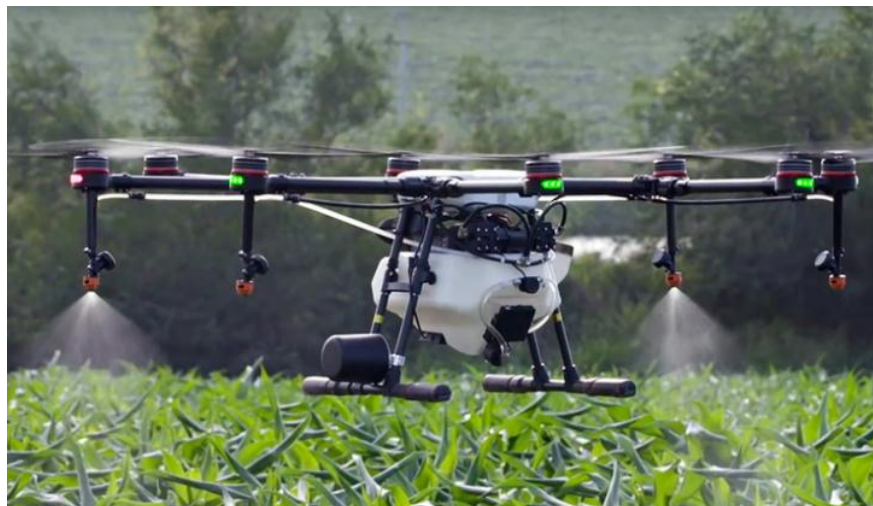
Рисунок 2. Беспилотник для внесения удобрения и опрыскивания полей
