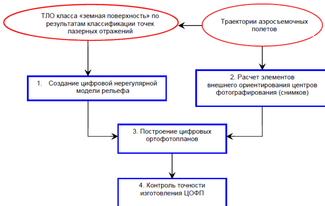
Рисунок 3 – Общая технологическая схема изготовления ЦОФП в программном обеспечении TerraSolid
