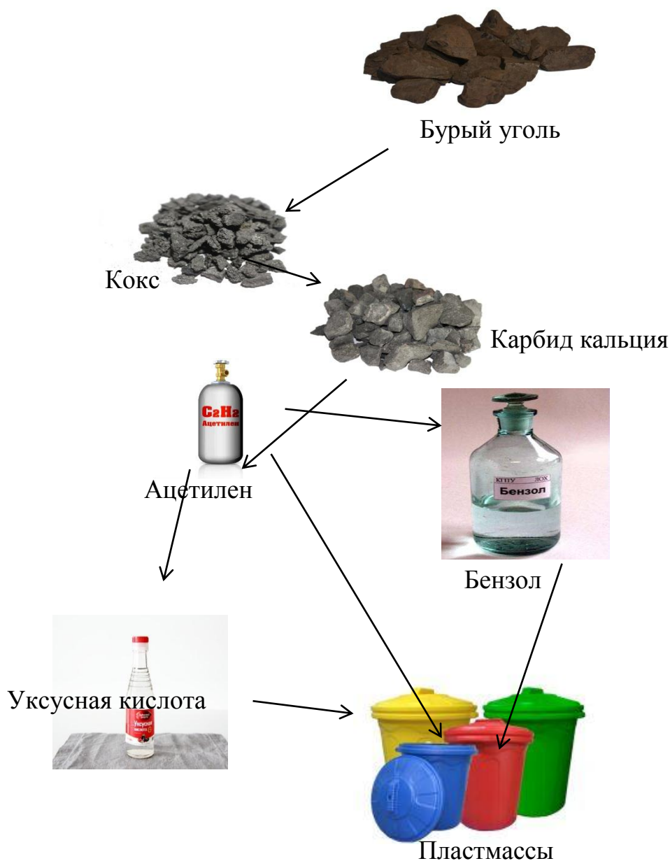
Рис.1 Схема переработки бурого угля с получением пластмассы
