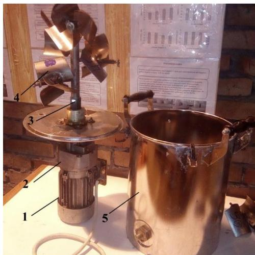
Рисунок 1 – Лабораторная тестомесильная машина
