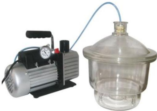
Рис. 1. Основные элементы лабораторной портативной установки для вакуум-сушки
