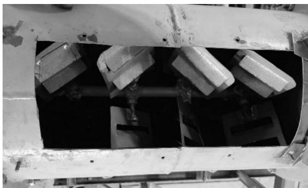
Рисунок 3 – Общий вид рабочего органа лопастного смесителя
