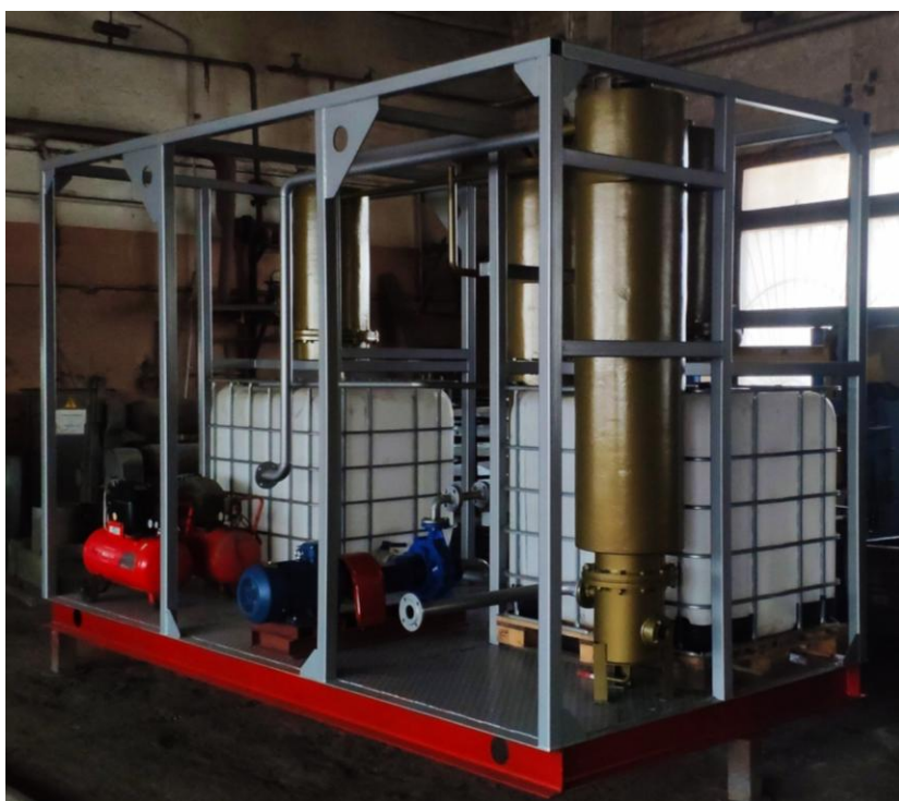
Рисунок 1 – Установка очистки биогаза
