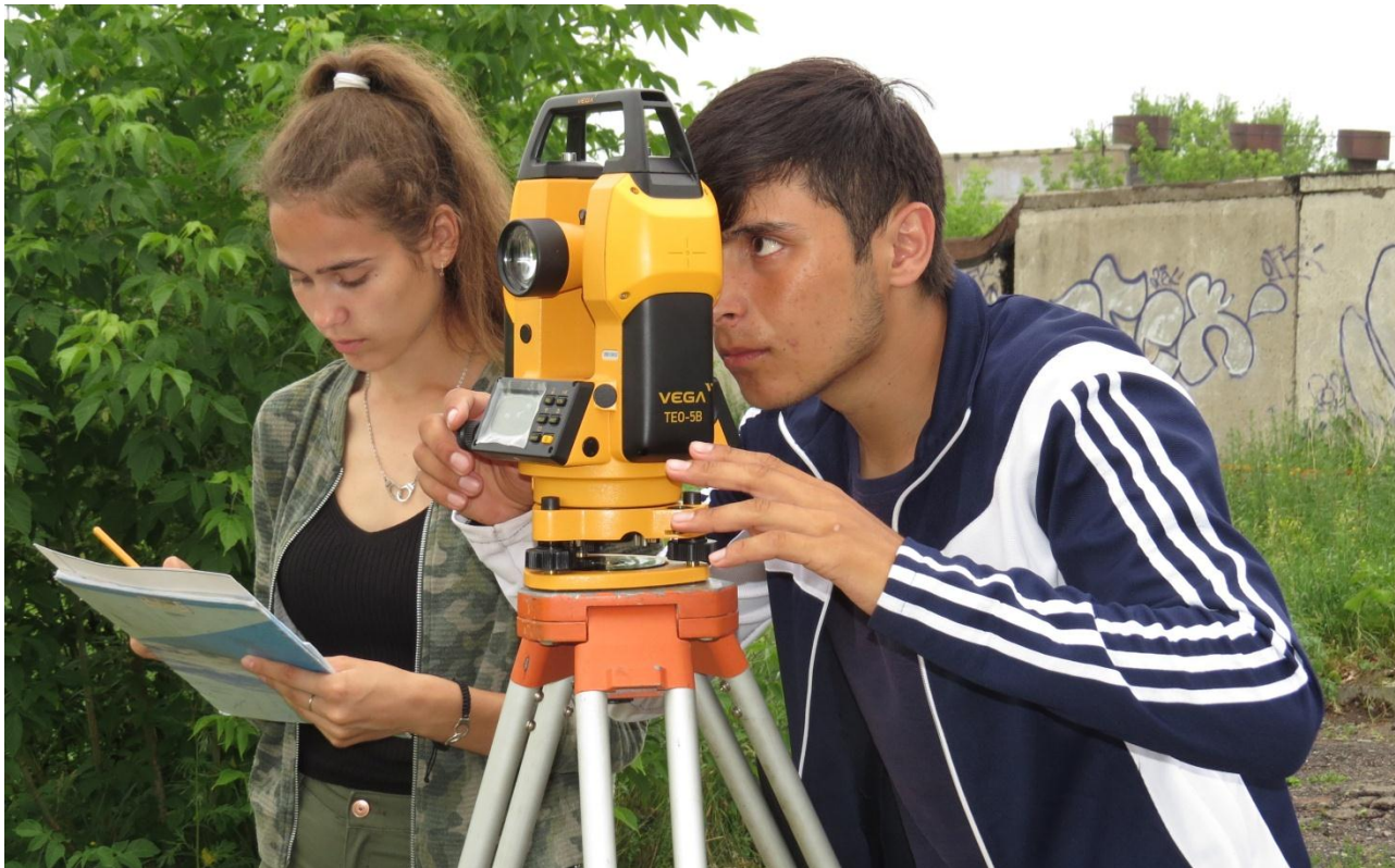
Рисунок 2 – Съёмка электронным теодолитом средней точности ТЕО-05В
