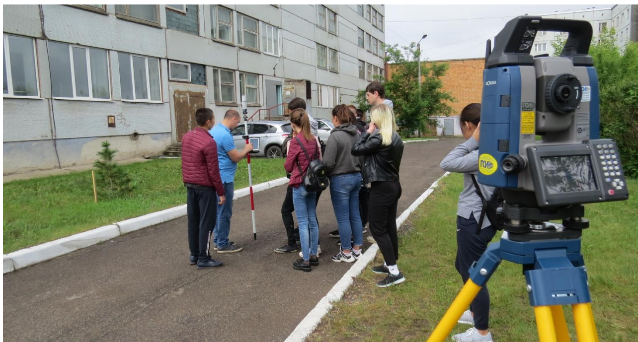
Рисунок 6 – Тахеометрическая съемка по технологии «гибрид» совместно роботизированным тахеометром и приемником ГНСС фирмы SOKKIA
