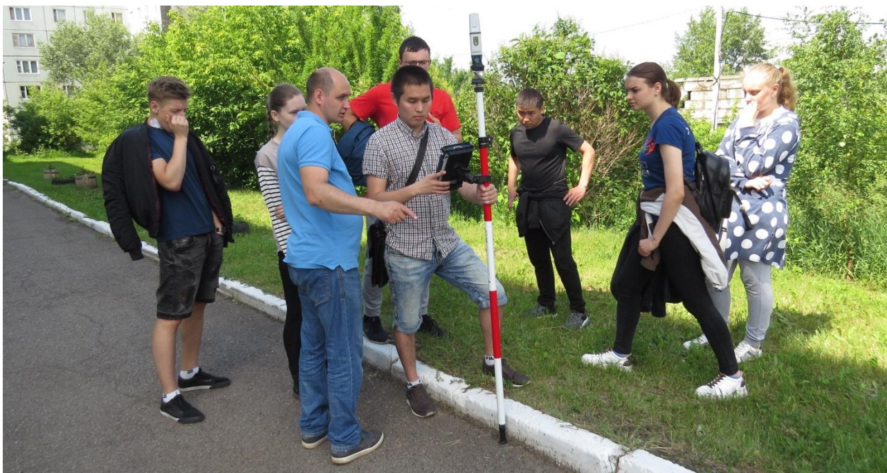
Рисунок 1 – Измерения ГНСС приемником фирмы SOKKIA
