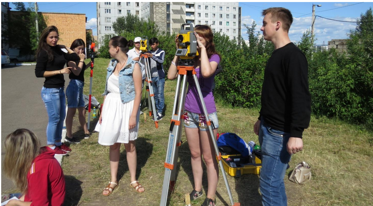
Рисунок 5 – Тахеометрическая съемка тахеометром M3 фирмы TRIMBLE
