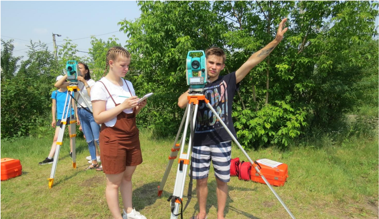
Рисунок 3 – Тахеометрическая съемка тахеометром SET610 фирмы SOKKIA
