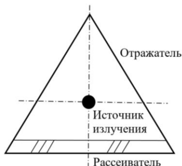
Рисунок 1 – К упрощенному теплотехническому расчету
