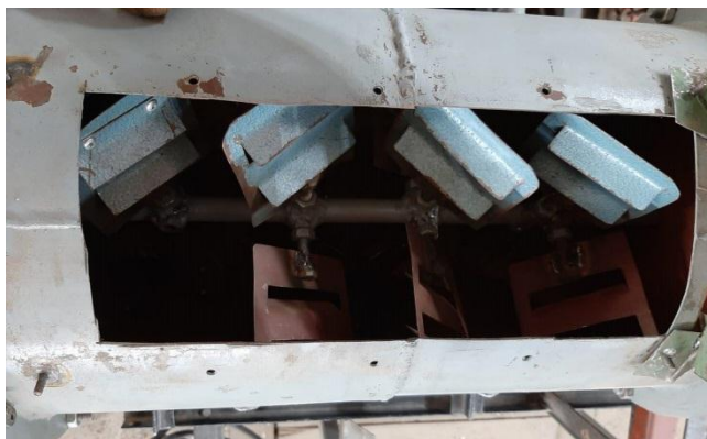
Рисунок 2 – Общий вид рабочего органа лопастного смесителя
