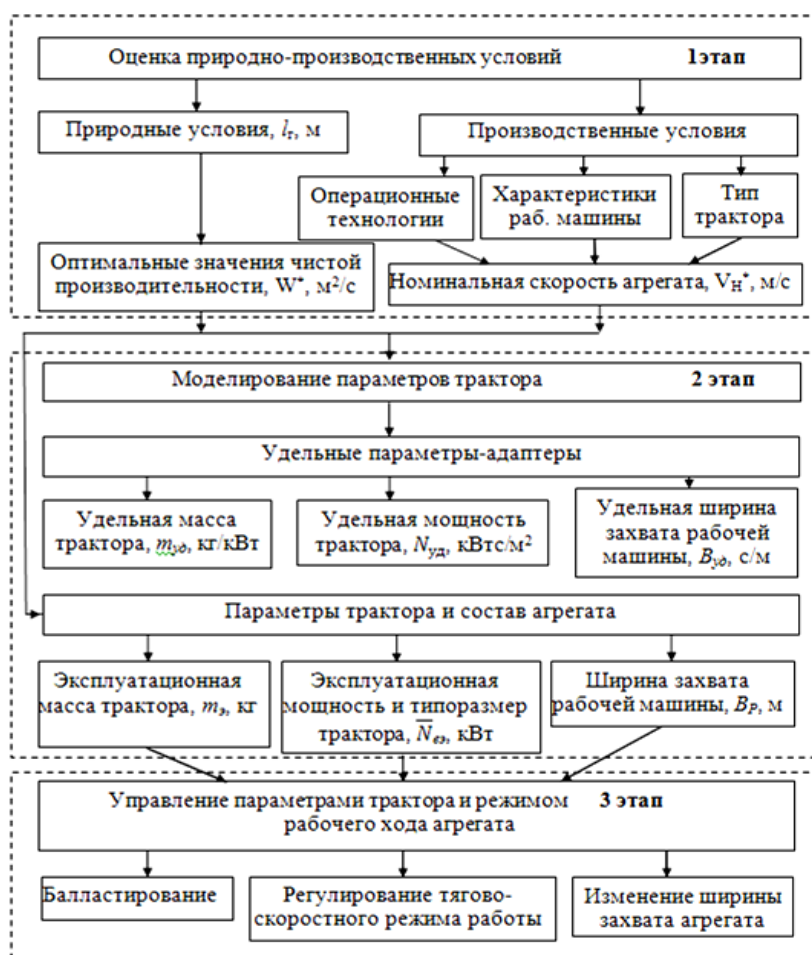
Рисунок 2 – Схема поэтапной оптимизации параметров и режимов работы агрегатов.
