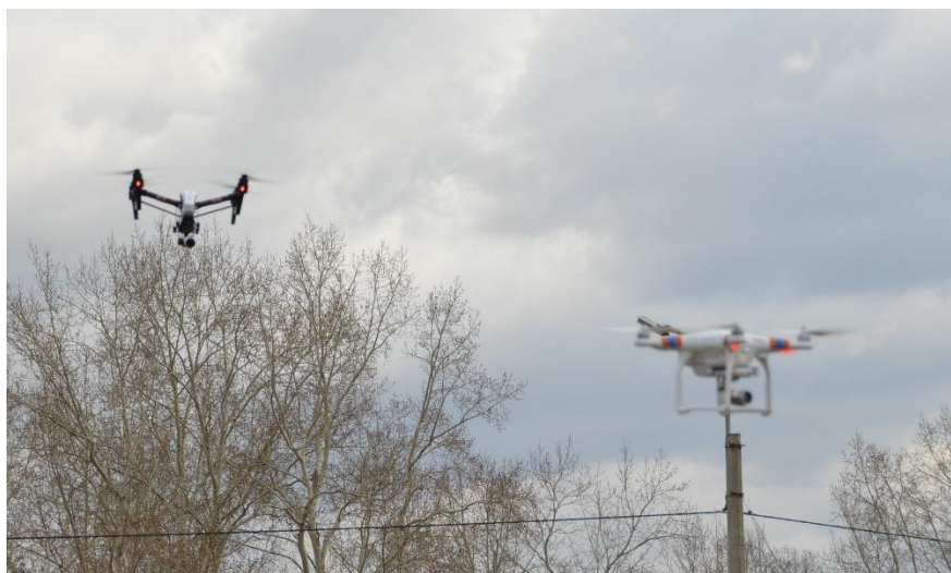
Рисунок 3 – Совместная планометрическая съемка двух БПЛА линии электропередач над полем.Россия, Емельяновский район Красноярского края
