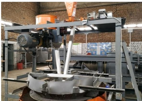
Рисунок 4. Общий вид центробежного смесителя
