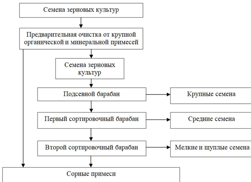
Рисунок 2. Технологическая схема очистки и сортировки семян зерновых культур
