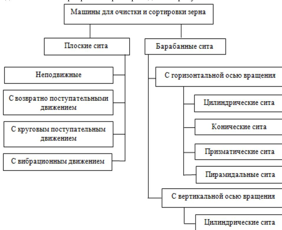
Рисунок 1. Классификация ситовых машин для очистки и сортировки семян зерновых культур
