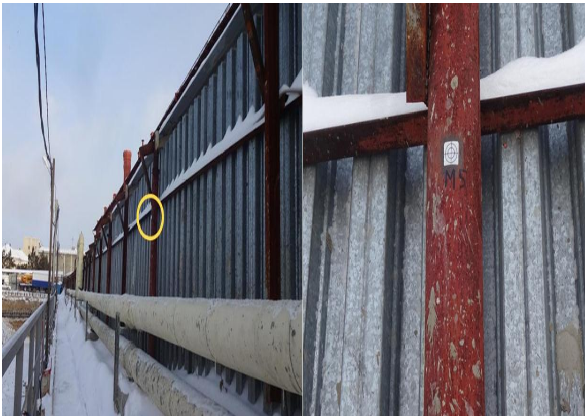
Рисунок 3 – Плёночный отражатель на столбе забора (M5)
