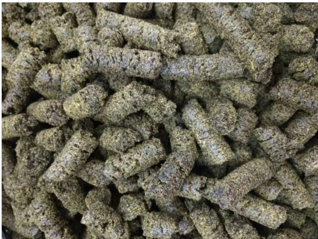
Рисунок 2 – Экструдированная продукция из жмыха рапса
