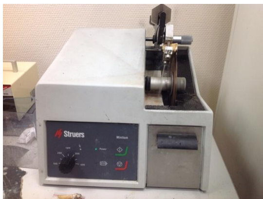
Рисунок 6 – Аппарат торцовочный Struers minitom, использовался для распиливания зубов (фото Твердохлеба П.А.)
