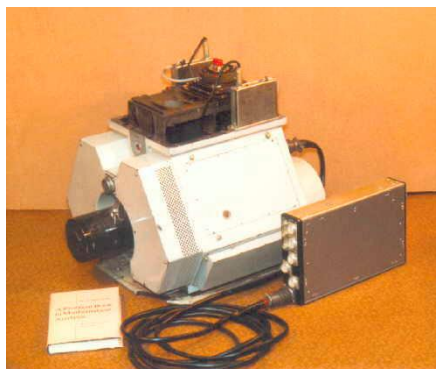
Рисунок 3- Тепловизор «Вулкан-400» с блоком управления
