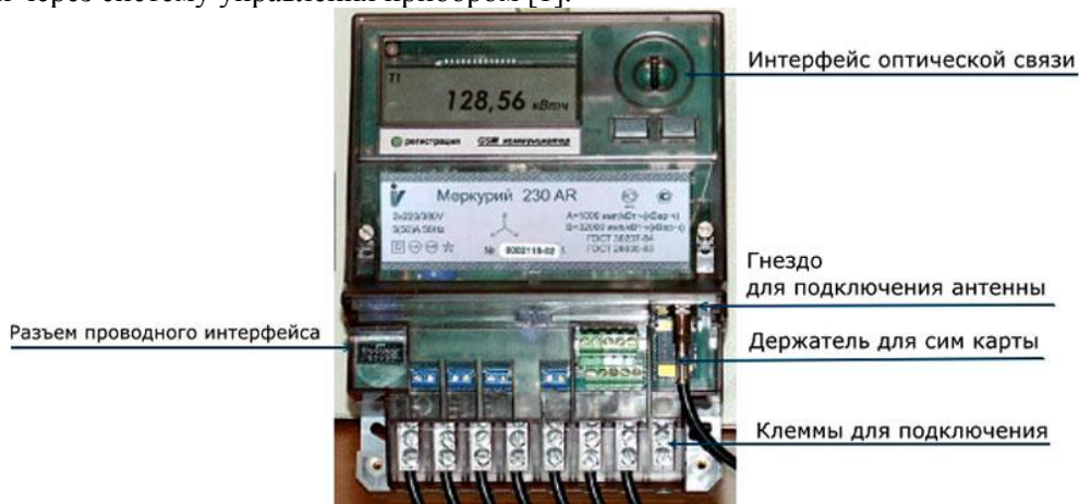
Рисунок 1 – Счетчик с дистанционным снятием показаний Меркурий 230 AR
