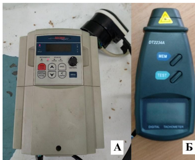
Рисунок-3 Оборудование для проведения эксперимента а- частотный преобразователь «ВЕСПЕР» E2-8300, б- цифровой лазерный тахометр DT2234A
