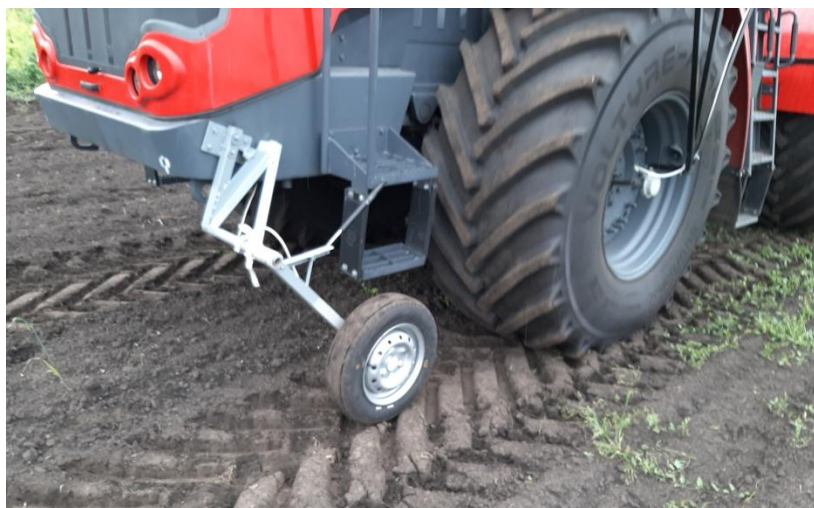
Рисунок 1 – Путеизмерительное колесо измерительных информационных систем ИП264
