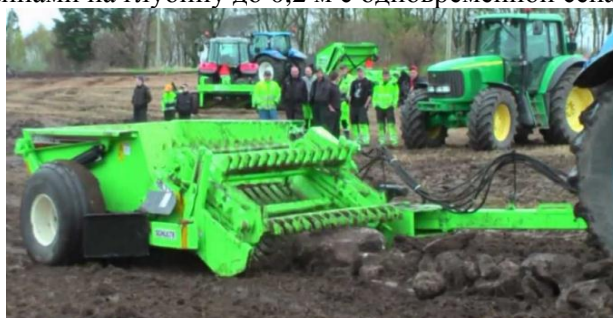
Рис. 3. Камнедробильный комбайн типа Agarin R.
