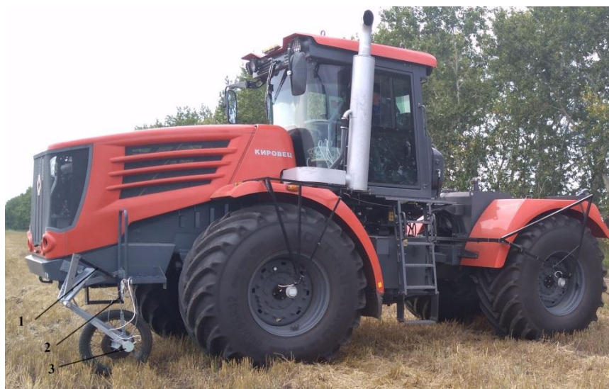
Рисунок 2 – Расположение элементов подвески путеизмерительного колеса на тракторе «Кировец» К-744Р2: 1 – амортизатор; 2 – пневмогидравлического упор; 3 – датчик оборотов
