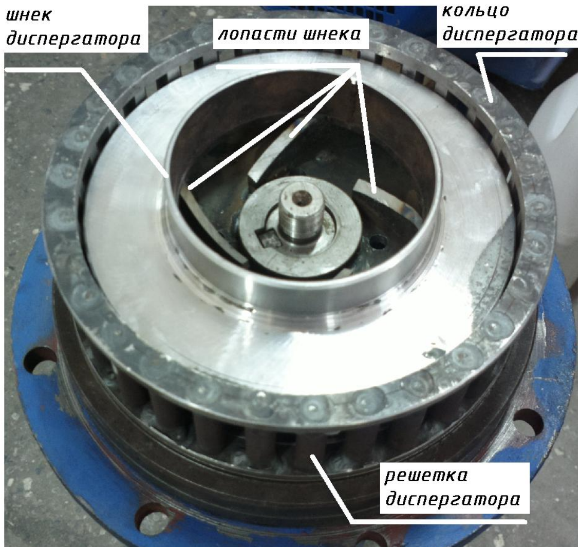
Рисунок 1 - Конструкция диспергатора для разрыва зерновки крахмала зерна на сахара используя ферменты.
