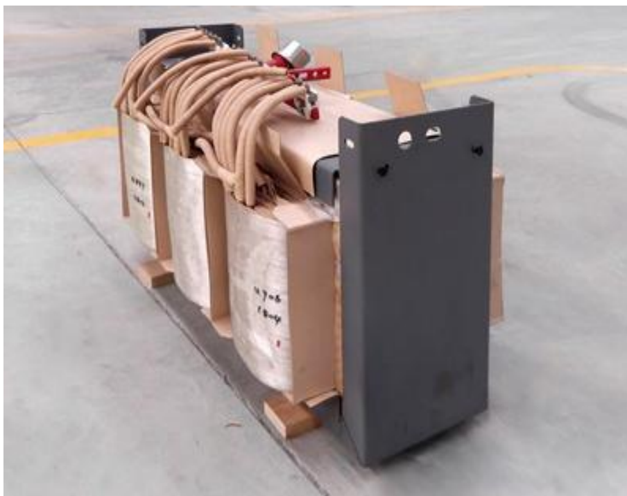
Рисунок 2 – Активная часть трансформатора с АТМГ
