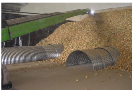
Рисунок 3 - Полукруглый вентиляционный тоннель.
