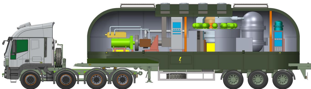
Рисунок 1. – Гибридная транспортабельная атомная станция с газоохлаждаемым реактором АТГОР
