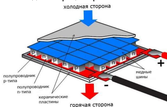
Рисунок 1- Элемент Пельтье
