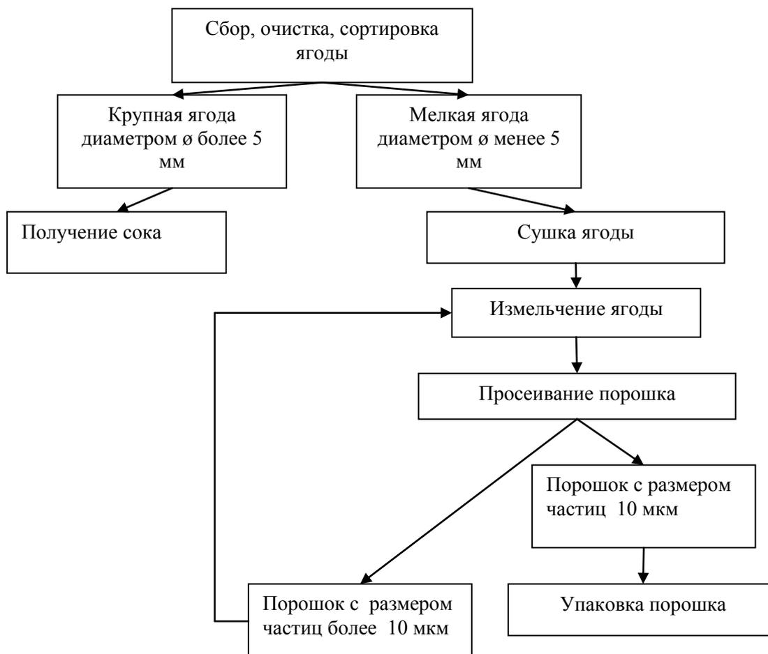
Рисунок 1 – Принципиальная схема переработки ягоды
