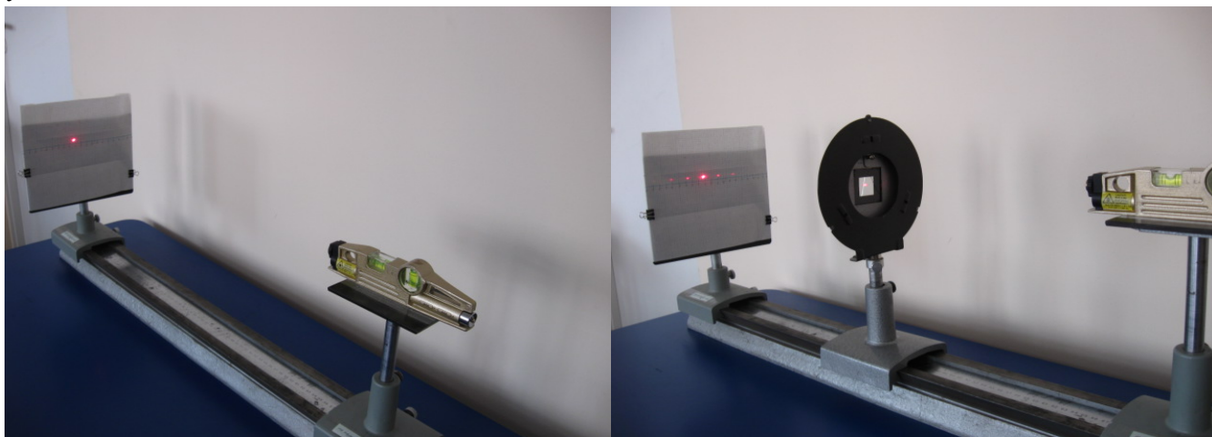
Рис. 1. Установка для наблюдения дифракции света
