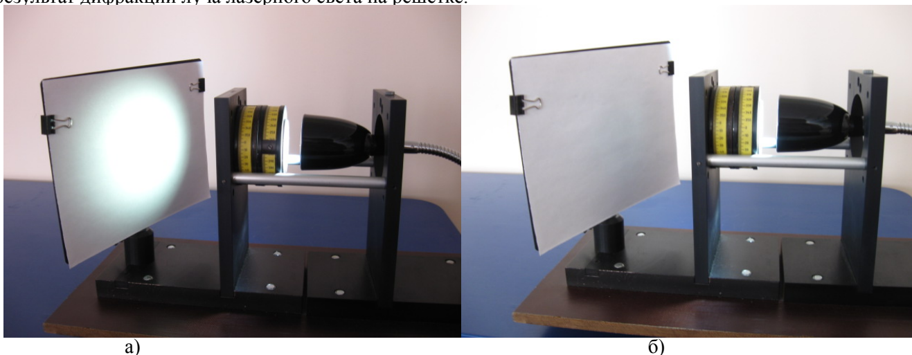
Рис. 2. Установка для наблюдения поляризации света
